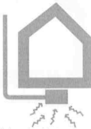
Figura 13: depressione del sottosuolo tramite pozzetto.
