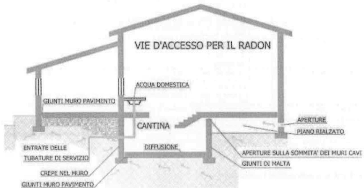
Figura 5: vie d'accesso per il radon
