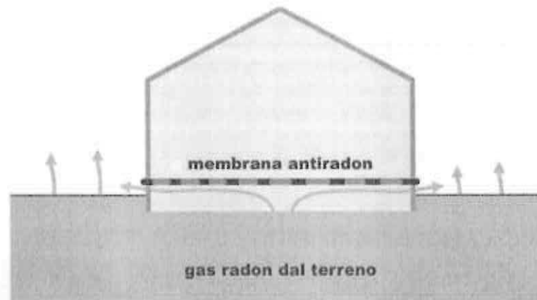
Figura 6: una membrana impermeabile antiradon di separazione fra l'attacco a terra e l'edificio è un sistema efficace nei confronti dell'ingresso del radon nelle abitazioni, purché attentamente posata.
